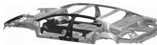
图 1 车身热冲压成形结构件
